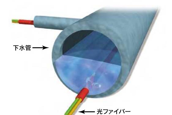
下水管にケーブルを布設することにより、マルチメディア社会に対応した情報通信網の構築を可能にする。
