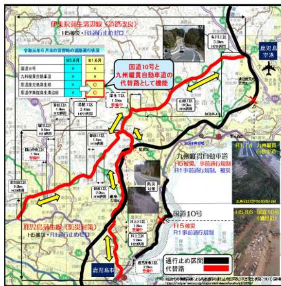
■災害時の幹線道路代替機能を確保した事例
