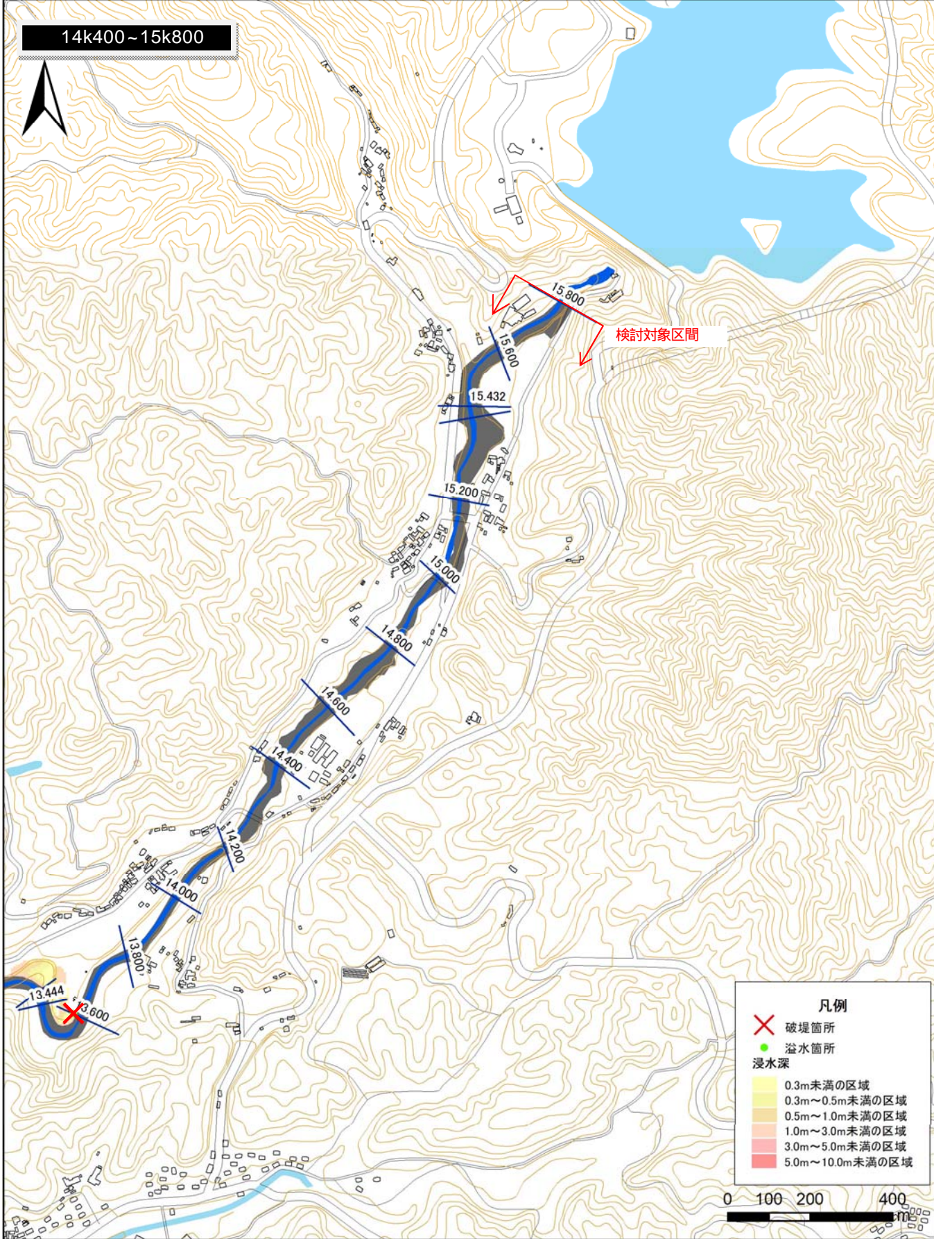
図 2.7-4 浸水解析結果拡大図 (14k400~15k800)
