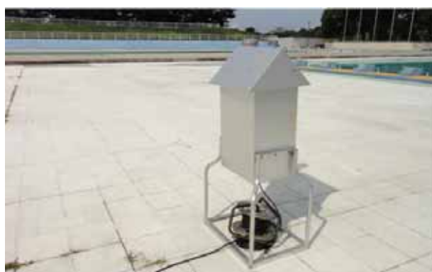
< ハイボリュームエアースンプラー（市民プール） >
