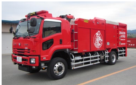
大型放水砲搭載ホース延長車
