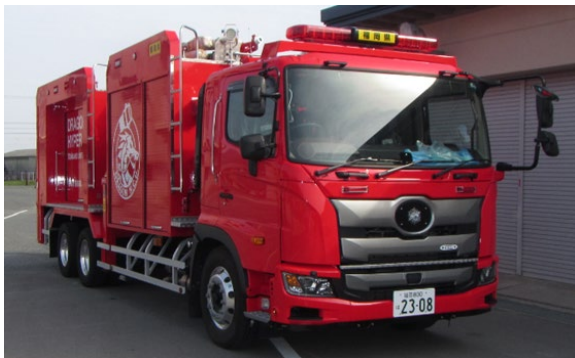
大容量送水ポンプ車
