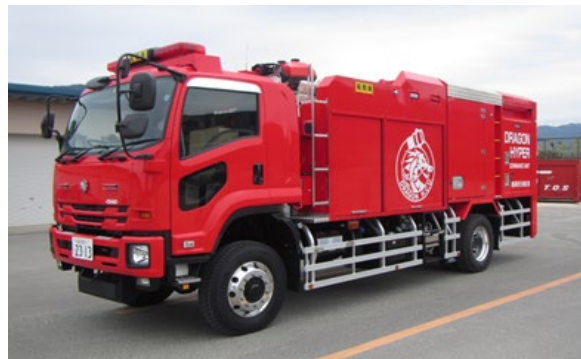
大型放水砲搭載ホース延長車
