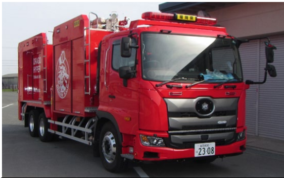
大容量送水ポンプ車
