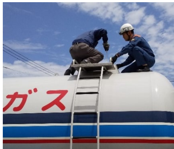
高圧ガスローリーの保安検査
