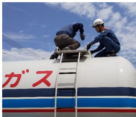
高圧ガ스로リーの保安検査
