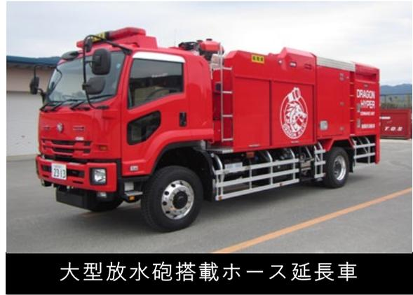
石油コンビナート災害等に対処するため、火災現場まで最大1 kmの長距離ホース延長をすることができ、かつ車両上部の大型放水砲から毎分8,000ℓの放水を行うことができます。
