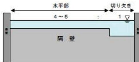
図4.7.3-9 隔壁部の切り欠き
