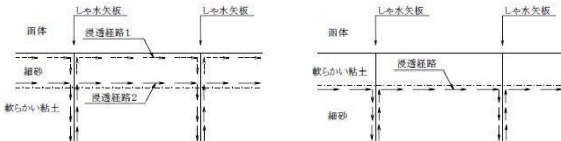
図4.1.4-21 互層地盤の鉛直方向の浸透経路の検討例
