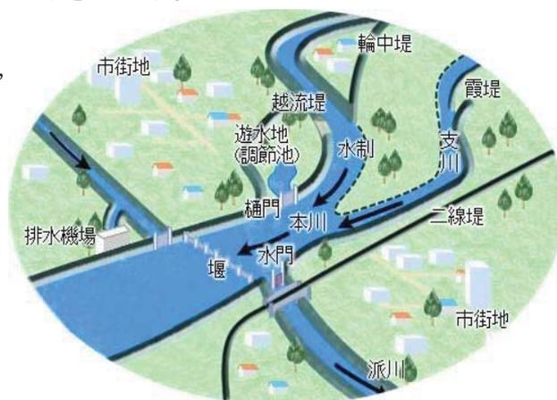
図 4.1.1-1 樋門・水門の概要図
