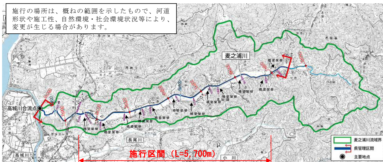
図 5-4 河川工事の施行の場所
