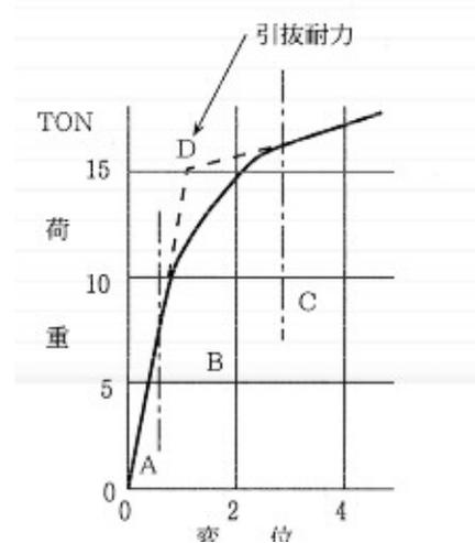
図4-1 ロックボルト引抜試験
