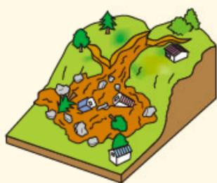
土石流は、谷間で起きます。大量の土・石・砂等が集中豪雨など大量の水と混じり合って流れてくるので、速度が速く大きな破壊力を持っています。
