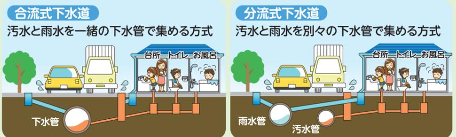
合流式下水道は、一本の下水管で汚水処理と浸水対策が同時にできる一方で、強い雨が降ると、処理しきれない分の汚水混じりの雨水が直接川に流れてしまうという課題があります。こうした課題への改善策のほか、さまざまな水質浄化の取り組みを進めています。
