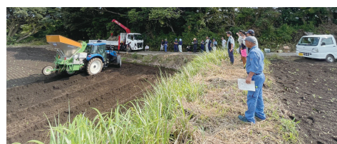
さとうきびのビレットプランターにおける自動操舵システムの実証活動
