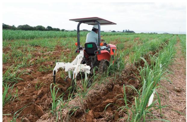
けん引式中耕機（スクープ）による作業の効率化（中耕ロータリ作業時間と比較し、1/4に短縮）
