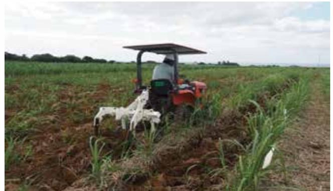
けん引式中耕機（スクープ）による作業の効率化（中耕ロータリ作業時間と比較し、1/4に短縮）
