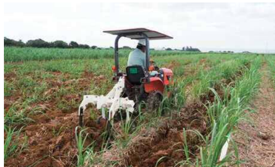
けん引式中耕機（スクープ）による作業の効率化（中耕ロータリ作業時間と比較し、1/4に短縮）
