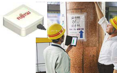
Wi-Fi を活用したセンシング技術により地下鉄駅構内の混雑状況を可視化
